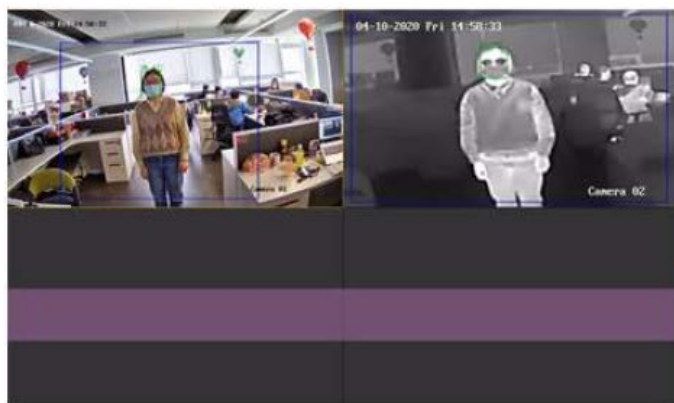
Пример эффективной зоны обнаружения для объектива 3 мм
