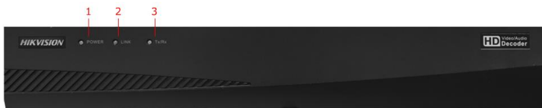
Рисунок 2.2 Передняя панель DS-6404/6408/6410/6412/6416HDI-T
