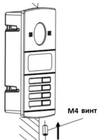
Рисунок 5-4 Установка вызывной панели (DS-KV8X02-IM)
